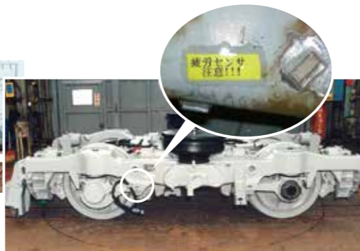
▲ 鉄道車両台車枠への疲労センサ適用
