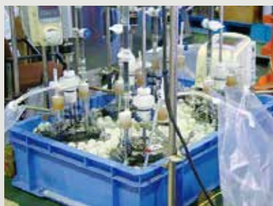
基礎データ取得のためのラボ試験 (ビーカーでの発酵試験)
