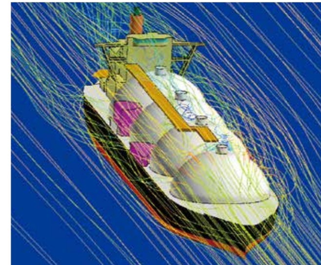
▲ LNG船風速・風向計位置検討用流れ解析
