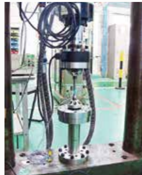
▲ 軸力疲労試験(最大荷重±100kN)
