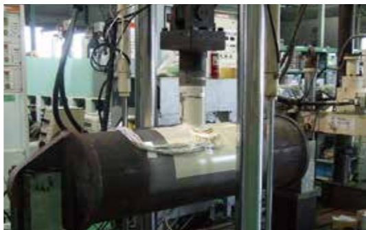
▲ 大口径パイプ曲げ疲労試験(最大荷重±200kN)
