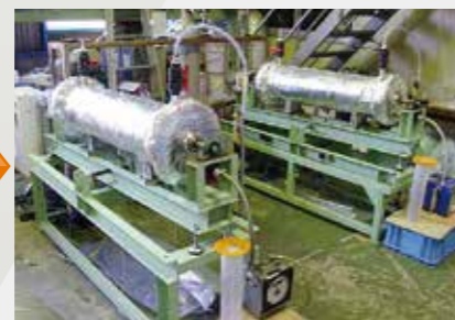
スケールアップのための要素試験 (発酵槽の攪拌機器性能試験)
