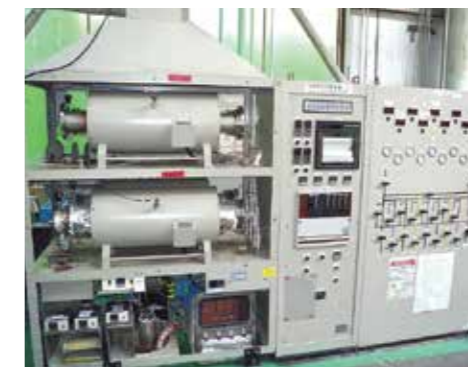
▲ 高温腐食試験装置 (温度: 200~900℃)
