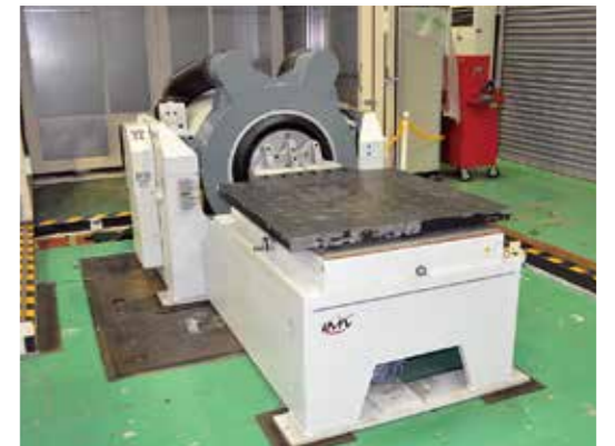
▲ 動電型振動試験機(最大加振力54kN)
