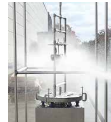
▲ 防水試験 (IPX6K試験)
