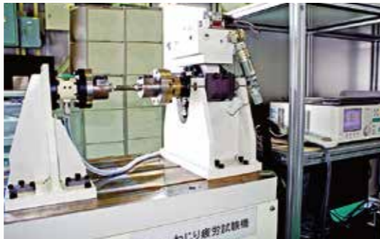
▲ ねじり疲労試験(最大トルク±0.5kN・m)
