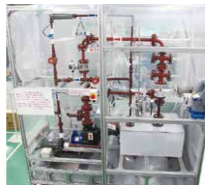
▲ 流動水腐食試験装置 (温度: ~90℃ 流速: ~20m/s)
