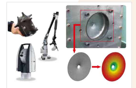
▲ 3D計測 形状計測・形状解析 (空気砲 貫通アルミ板 表面形状解析)
