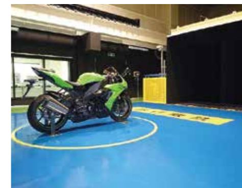
▲ 風洞試験 (風速: 180km/h max)
