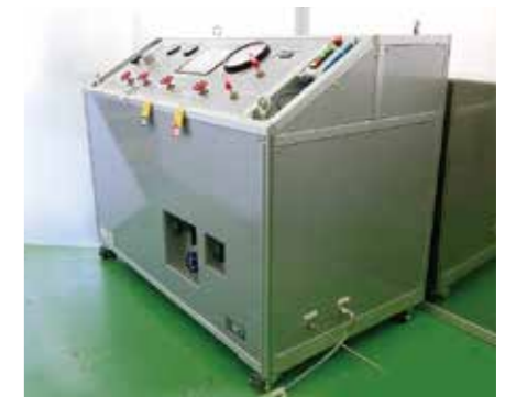
▲ 超高圧試験 (水圧) (試験圧力: 最大200MPa、サイクル時100MPa)
