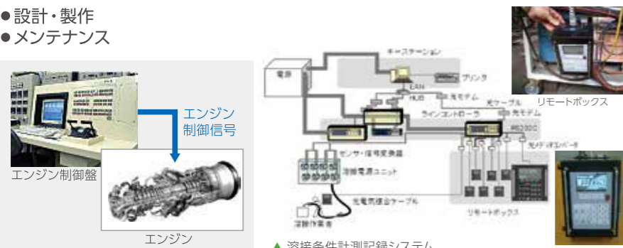
▲タービンエンジン計測システム
