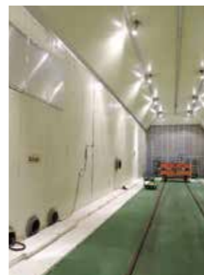
▲ 大型環境試験室 (寸法: 5.4W×32D×6H m)
