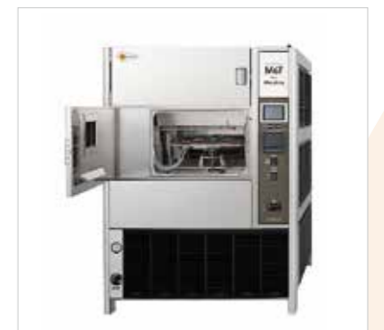
▲ メタリングウェザーメーター (放射照度: 0.8~2.5kW/m 2 )
