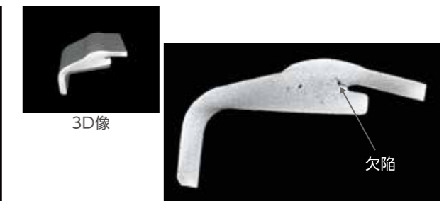
事例2 アルミ溶接部のX線CT結果
