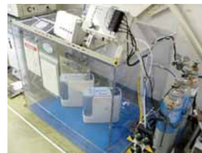
▲混合ガス腐食試験装置 内寸 1200mm×880mm×980mmH ガス種類 H 2 S、SO 2 、Cl 2 、NO 2 など 準拠規格 JIS C 60068-2-60他
