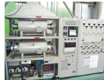
▲ 高温腐食試験装置 (温度: 200~900℃)
