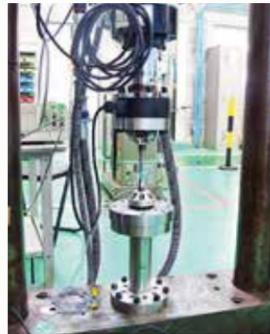
▲ 軸力疲労試験(最大荷重±100kN)
