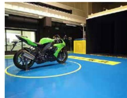
▲ 風洞試験 (風速: 180km/h max)
