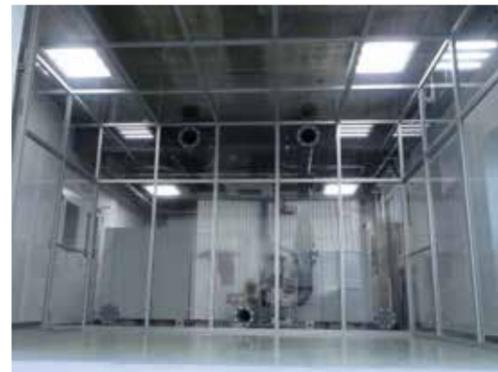
▲ 防じん試験室 (試験室: W4.3m×D3.0m×H2.9m)
