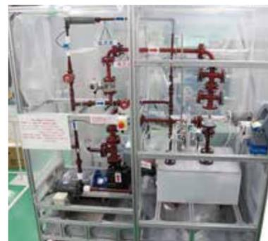
▲ 流動水腐食試験装置 (温度: ~90℃ 流速: ~20m/s)
