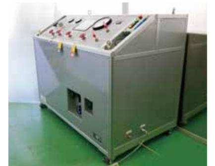
▲ 超高压試験 (水圧) (試験圧力: 最大200MPa、サイクル時100MPa)
