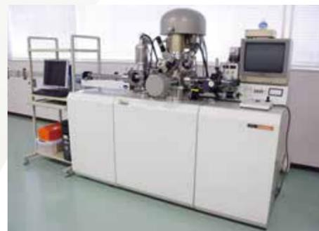
▲ 全反射X線光電子分光分析装置
