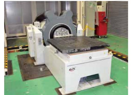
▲ 動電型振動試験機(最大加振力54kN)
