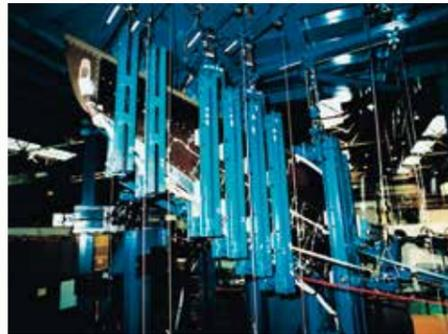
▲ ウイングレットの強度試験(米航空局認定試験)
