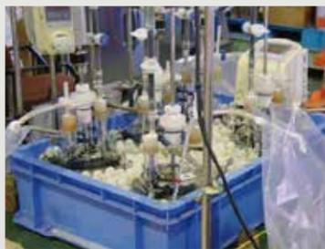
基礎データ取得のためのラボ試験 (ビーカーでの発酵試験)
