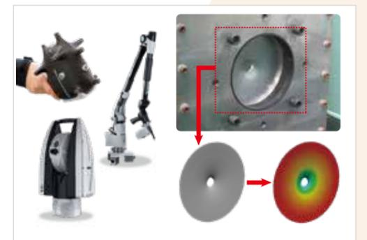
▲ 3D計測 形状計測・形状解析 (空気砲 貫通アルミ板 表面形状解析)
