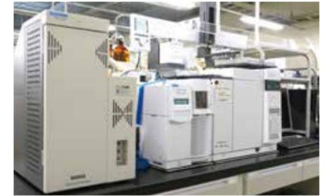
▲ 加熱脱着ガスクロマトグラフ質量分析装置
