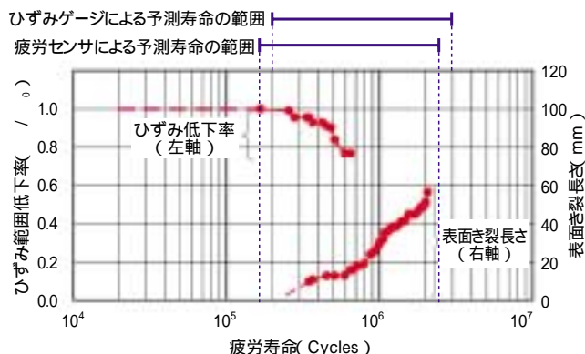
図4 プレートガーダー実証試験の結果 Fig. 4 Fatigue crack prediction and actual generation
