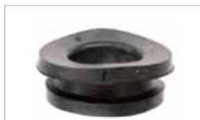
変形したパッキン
