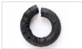
き裂、破断したOリング
