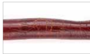
変色、損傷したゴムチューブ
