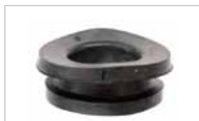
変形したパッキン
