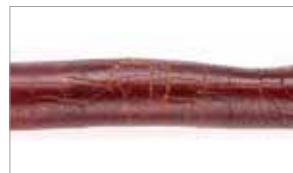
変色、損傷したゴムチューブ
