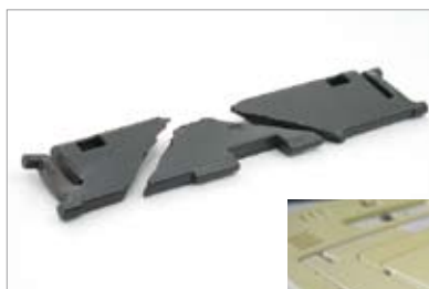
破損した樹脂部品
