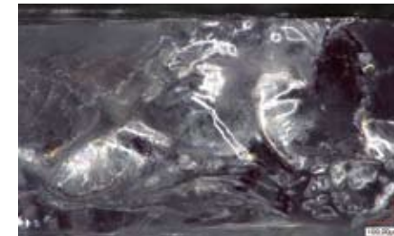
溶剤き裂破面のマイクロスコープ観察像 溶剤き裂特有の鏡面状の破面が見られます。
