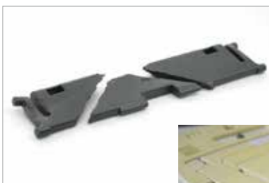
破損した樹脂部品
