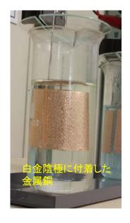
銅合金などの金属試料を酸で完全に溶解します。その溶液を、電気分解分析装置にて白金電極を用いて電解し、陰極に直接金属銅を析出 (メッキ)させます。電極の質量を秤り、その電着増量にてCu量を求めます。
