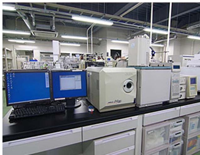
熱分解ガスクロマトグラフ質量分析計
