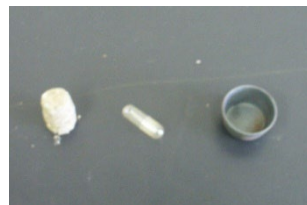
左から 試料ペレット(ごみ) ゼラチンカプセル 測定用ルツボ
