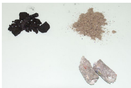
左： 石炭 約33000 J/g 右下： RDF 右上： RDFを微粉碎 約22000 J/g
