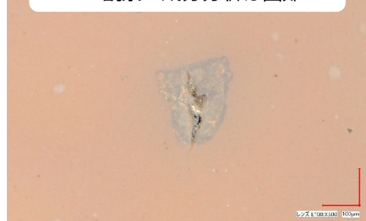
図4 一般溶剤を用いた異物取出し例
