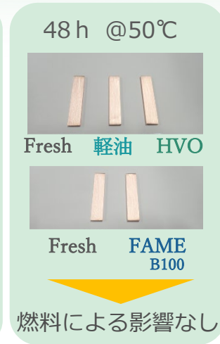
図7 銅板腐食試験
