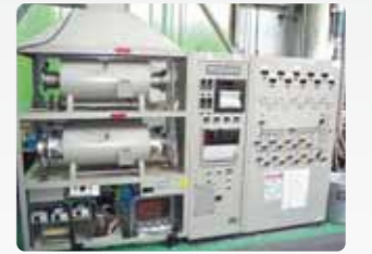
▲高温腐食試験装置
