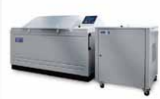
▲大型複合サイクル試験装置
