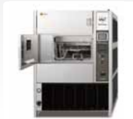
▲メタリングウェザーメータ試験装置
