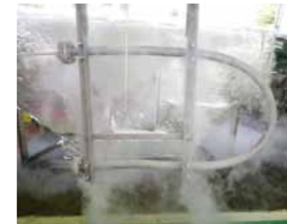
▲低温耐圧試験 試験温度 約-190℃ 浸漬液 液体窒素 加圧媒体 Heガス
