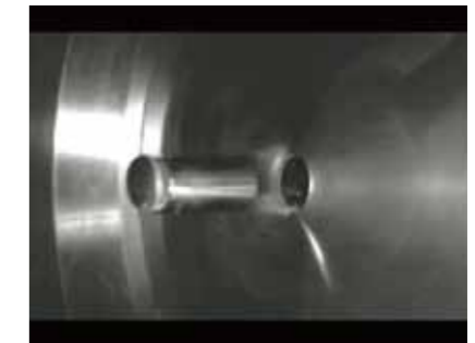
▲空気砲衝突試験(例:アルミ板貫通試験) 飛翔体寸法 φ10~φ120mm 最大能力 6000Nm 衝突速度 最大 500km/h (衝突物の形状と重量による)
