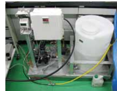
▲水圧サイクル試験装置 試験圧力 最大40MPa 昇圧時間 10あたり1秒~ 対象製品 機械部品、小型容器、継手など
