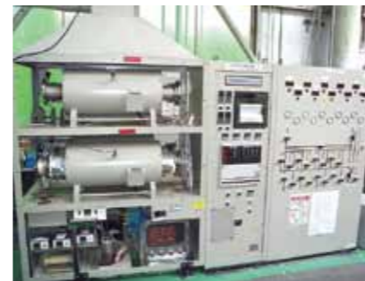
▲高温腐食試験装置 推奨試験片寸法 10mm×10mm×3.0mm t 最高温度 900℃ ガス種類 H 2 S、SO 2 、HClなど
