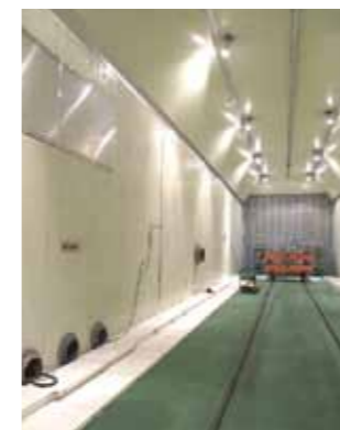
▲大型環境試験室 試験室寸法 5.4m(W)×32m(D) ×6m(H) 温度範囲 -40℃~50℃ 湿度範囲 25%RH~90%RH (温度により湿度調整範囲は異なる)
