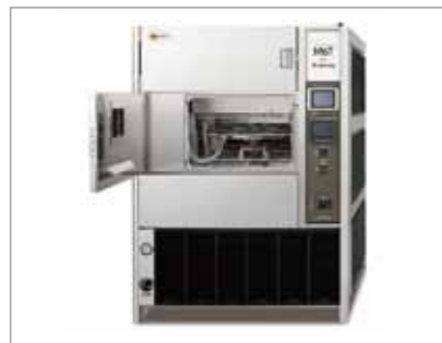
▲メタリングウェザーメーター 放射照度 0.80kw/m 2 ~2.50kw/m 2 (295nm~450nm) 有効照射面 440mm×180mm 温度範囲 30℃~85℃ 湿度範囲 30%RH~70%RH
