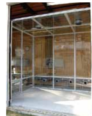
▲大型防じん試験室 試験室寸法 3.6m(W)×2.5m(D) ×3m(H) 準拠規格 JIS C 0920 (IP試験) JIS E 4036、 JIS D 0207など
