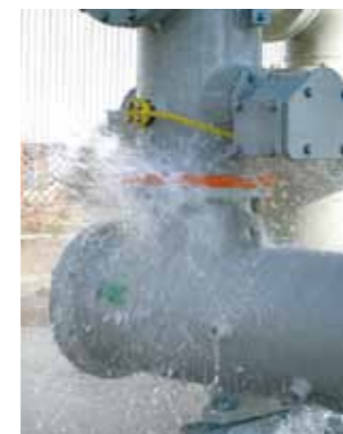
▲防水試験 準拠規格 JIS C 0920 (IP試験) NDS C 0110Eなど 大型試験体(1辺2m超)に対応
